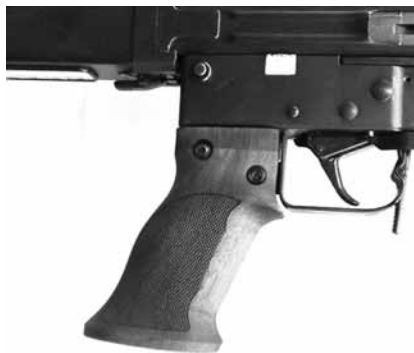
Figura 13: impugnatura a pistola Tactical per F ass 57, diversi modelli
