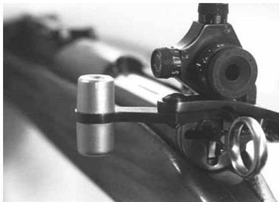
Figure 13: Verrou à gauche pour mousqueton 31
