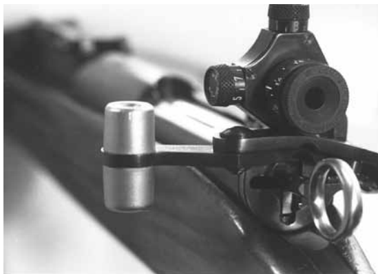
Bild 13: Linksriegel zu Karabiner 31
