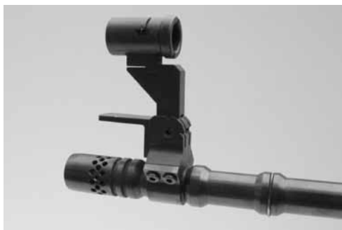
Bild 10: Kornträger als Visierverlängerung (Laufmontage), diverse Fabrikate
