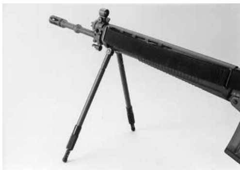
Bild 2: Verstellbare Zweibeinstütze zu Stgw 90, diverse Fabrikate
